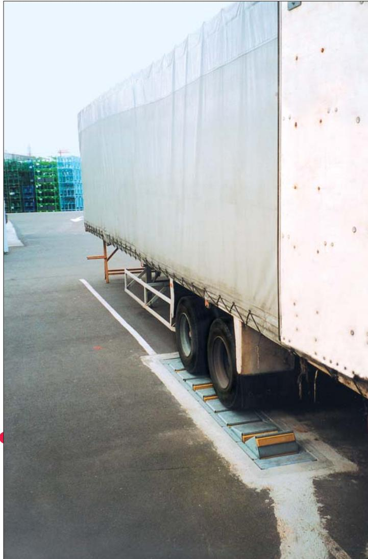
Die einzelnen Radkeile der LKW-Sicherung klappen hoch bis das LKW-Rad Widerstand bietet.
